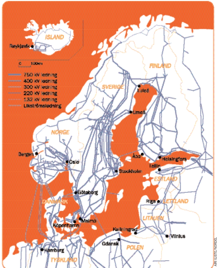
4 Från norr till söder. Det första svenska stamnätet för högspänning började byggas på 1930-talet. Under 1950-talet byggdes nätet ut med högre kapacitet. Tio år senare tillkom de första förbindelserna med de nordiska grannländerna, och under 1990-talet skedde integreringen i det europeiska elsystemet genom högspända likströmskablar under vattnet till Tyskland och Polen.
